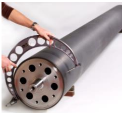
CFRP ロールに コートした RCC
